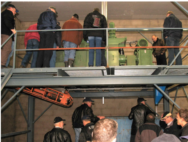
Den nyaste oljepressen står på en ställning så att oljan kan rinna ner i behållarna nedanför.
