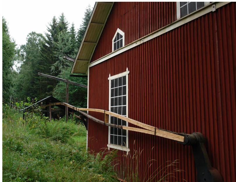
Här kommer veven från vattenhjulet som drar en av vevstängerna.
